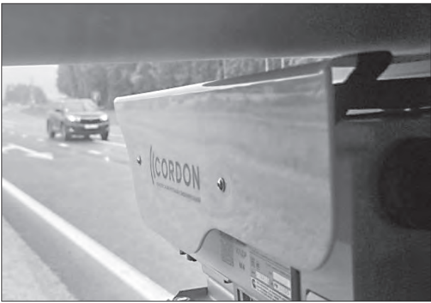
Аппаратура устанавливается на патрульные автомобили и способна фиксировать нарушения даже во время движения машины
